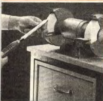
5/e Az él másik oldalának megmunkálásához a kést egyenletesen vissza kell forgatni...
