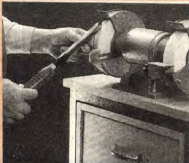
5/i Amint az élszalag a köhöz ér, a kést forgassuk az ívelt felületen és jobb kézzel egy kissé toljuk felfelé úgy, hogy az élszalag megfelelő ivben helyezkedjen el.
